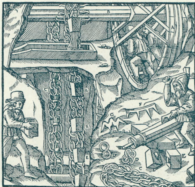
Das Tretrad, als Wasserfördermaschine.
