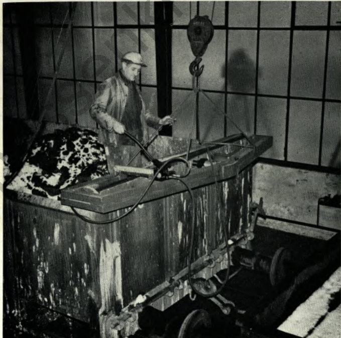
Richten von Kopflappen an O-Wagen mit der prämierten Vorrichtung.
