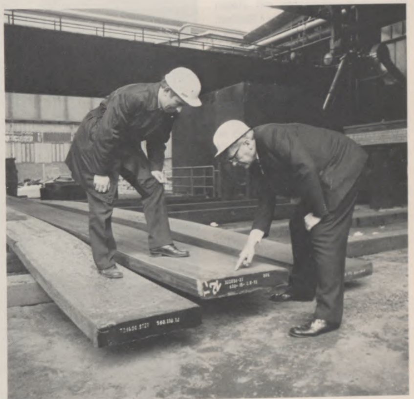
Der Leiter der Zurichterei Profilwalzwerk Westfalenhütte, Dipl.-Ing. Joachim Schumpelt, und sein Vertreter, Ing. (grad.) Alfred Kimpel, prüfen das Schleifbild an einer Bramme für Zieh-zwecke.
