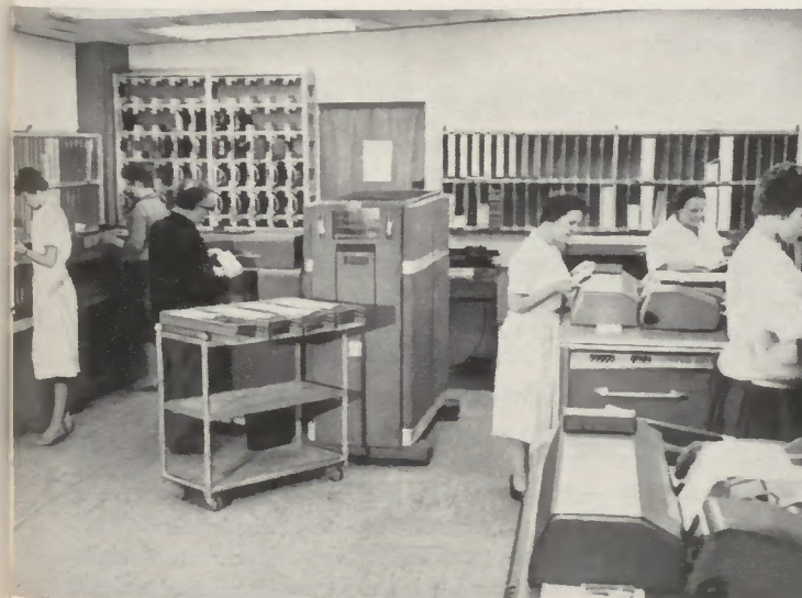
Teilansicht eines Maschinenraumes der Hollerith-Abteilung, in dem unsere Mitarbeiterinnen Lochkarten sortieren und an den Tabelliermaschinen Listen erstellen
