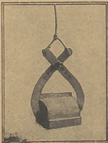
Steinzange zum Heben schwerer Lasten.
