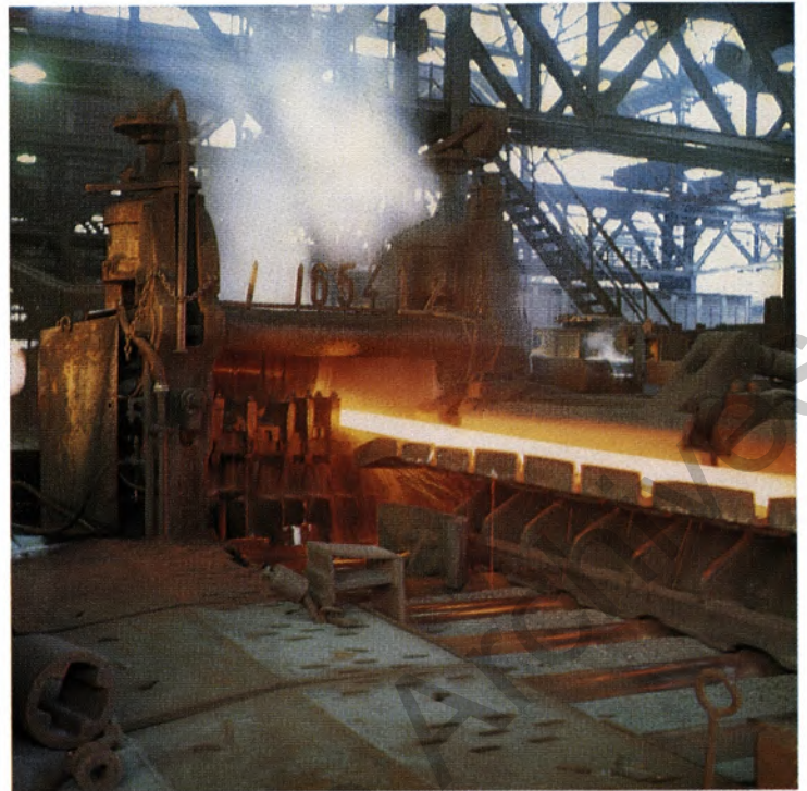
Vorwalzen eines Blockes am 650er Vorgerüst (B) zwischen Mittel- und Oberwalze. Auffangen des Blockes durch die Kantvorrichtung.
