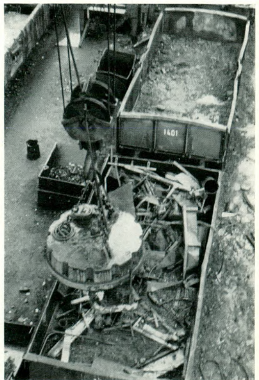
Hier soll mit einem im Haken hängenden Magneten eine Kokille transportiert werden. Man beachte die geringen Sichtverhältnisse zu beiden Seiten des Magneten beim Sinkenlassen.
