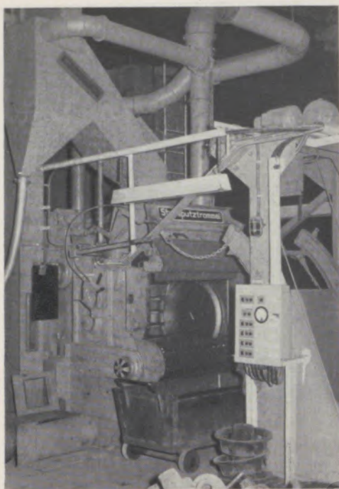
Wheelabrator-Putzanlage in Stachelhausen für kleine Gußstücke
