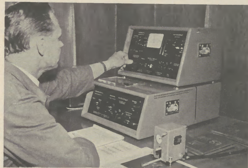
Gerät zum Messen der Oberflächen-Rauigkeit
