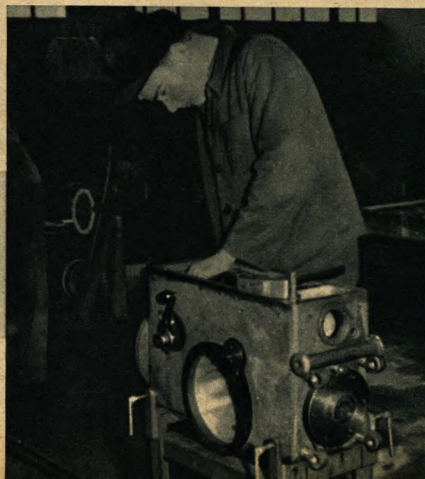
Schlosser Manfred Winkelmann bei der Montage des Getriebes in den Gehäuseblock des Einachsschleppers
