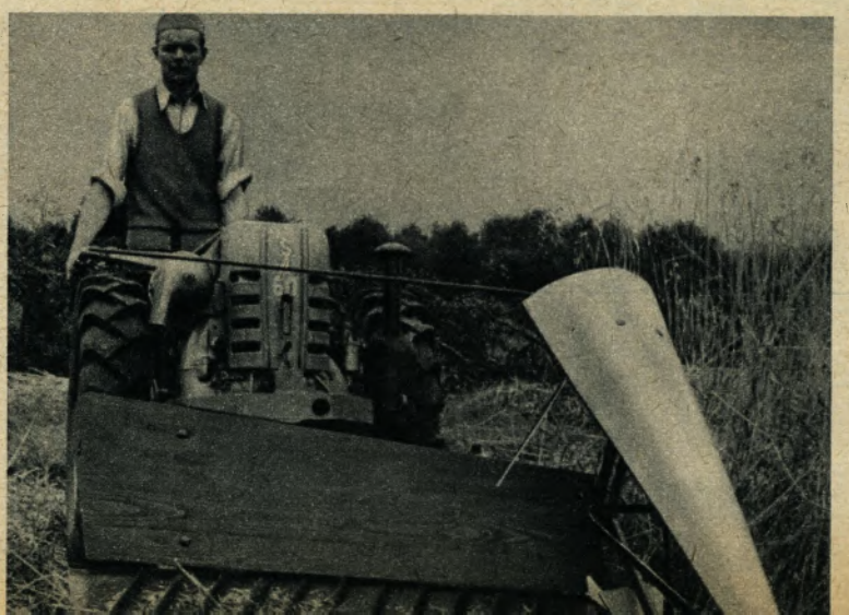
Der von der Schmiedag für den Einachsschlepper konstruierte Frontmäher mit Getreidemäheinrichtung ist das ideale Gerät für kleine und mittlere Betriebe der Landwirtschaft
