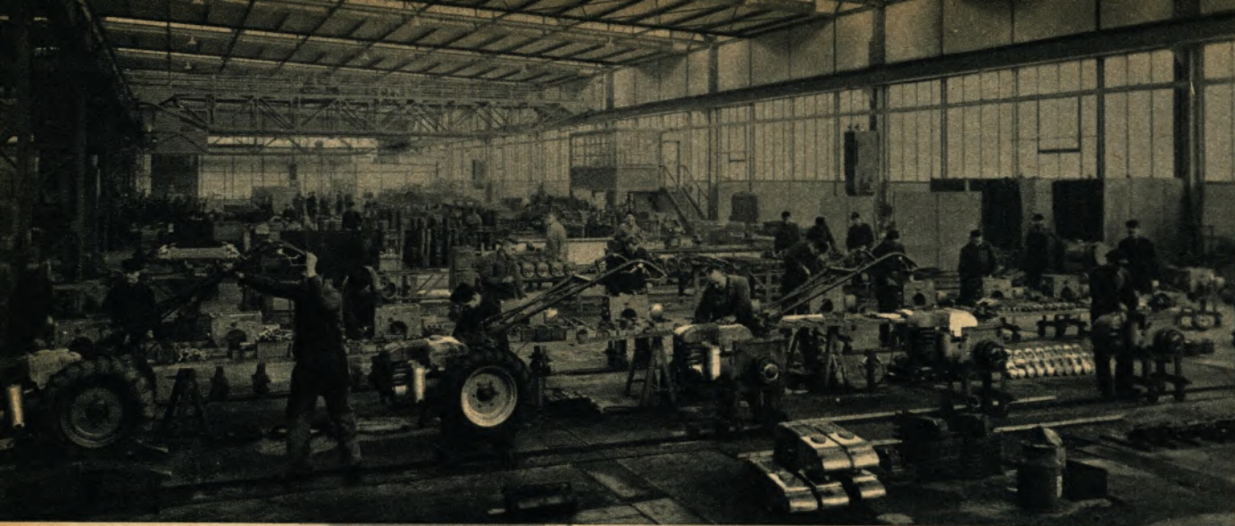
Blick in die großen, neuen Hallen der Schmiedag AG, Hagen. Unser Bild zeigt die Hansaschlepper-Montage am Band
