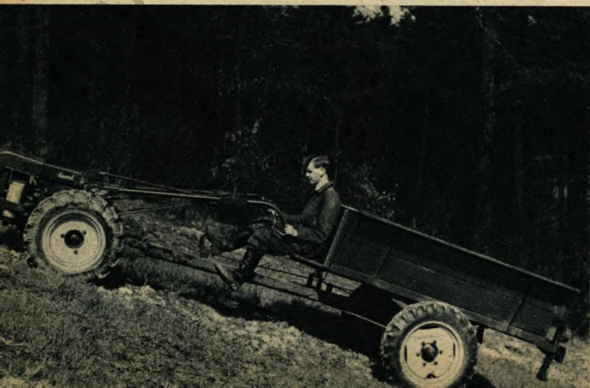
Der Hansaschlepper bewältigt mit dem Triebachsanhänger größte Steigungen. Bis zu 40 Zentner Tragkraft können dem Anhänger zugemutet werden.
