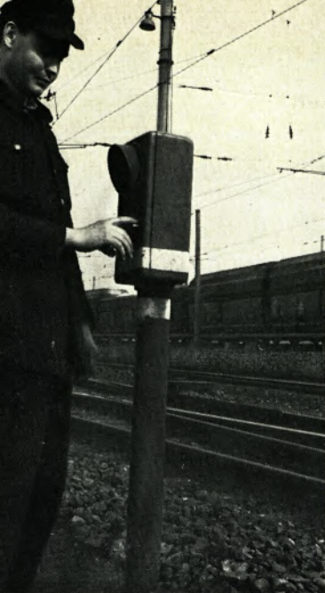
r Hackbarth benutzt hier eine Sprechanlage, mit deren Hilfe er sich lwerk verständigen kann. Auch diese Maßnahme dient dem flüssigen
