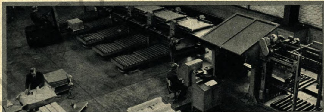
16 Zur Kontrolle der visuellen und automatischen Prüfungen in der Verzinnungsanlage wird ein Teil der Erzeugung bei geringerer Geschwindigkeit auf einer Nachsortieranlage (hier von Oskar Asbach) geprüft.
