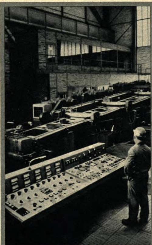
15 Die automatische Sortierstrecke (beobachtet von Lothar Günther) leitet die einzelnen Tafeln je nach ihrem Qualitätszustand in vier verschiedene Stapelboxen.
