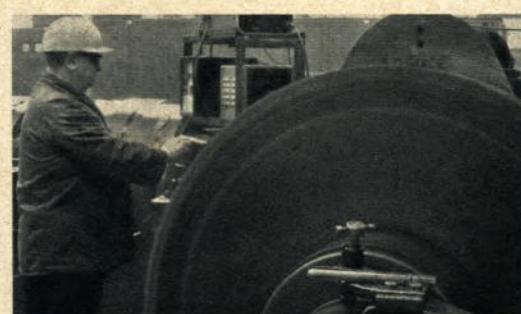
▲ Herbert Müller überprüft Kaltband mit einem Ultraschallgerät auf innere Fehler
