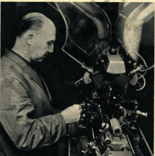
▲ Erwin Vollmer überprüft die Zerspanbarkeit von Automatenstahl
