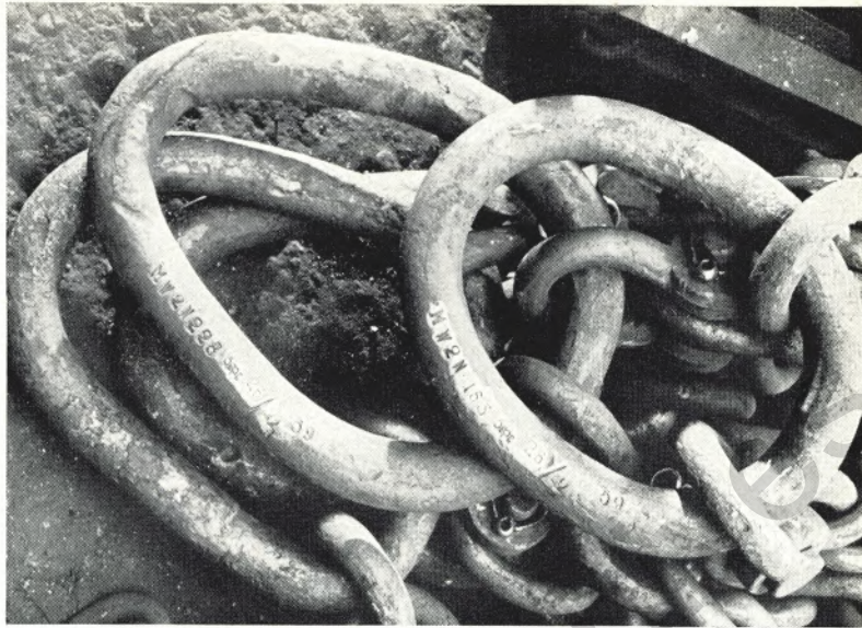
Diese beiden Ketten sind in Ordnung: Kette Nr. 163 (rechts) und Nr. 228 (links) wurden am 26. Februar 1959 geprüft, wie die Stempel auf dem Kettenring zeigen
