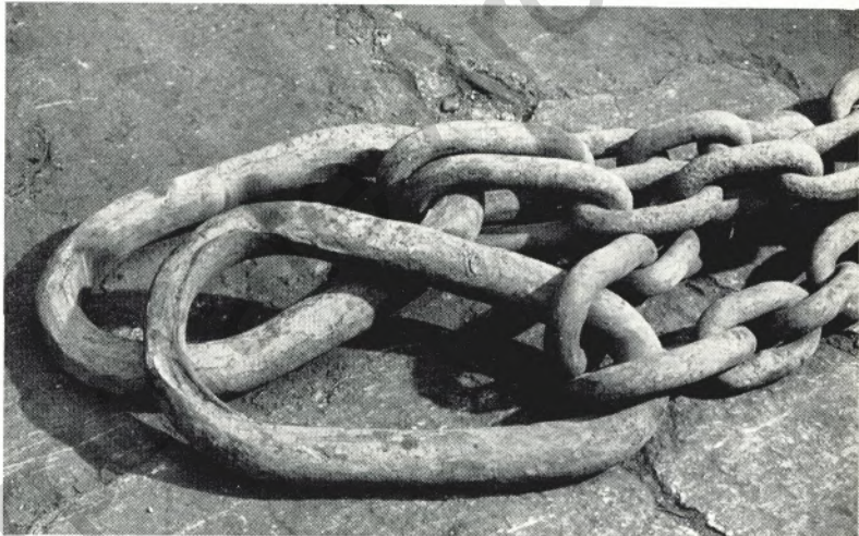
Bei dieser Kette sind die Ringe stark verschlissen, es besteht große Zerreißgefahr. Hier gibt es nur ein Gebot: Sofort zur Kettenschmiede
