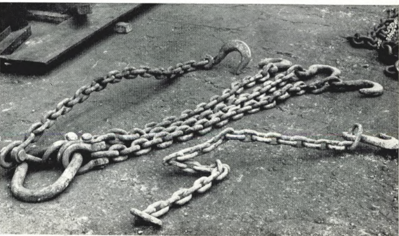
Steifgebogene Kettenstränge mit aufgebogenen Kettenhaken sind in höchstem Maße unfallanfällig, auf der oberen Kette außerdem noch ein gerissenes Kettenglied. Diese Ketten hätte man schon längst der Kettenschmiede übergeben müssen
