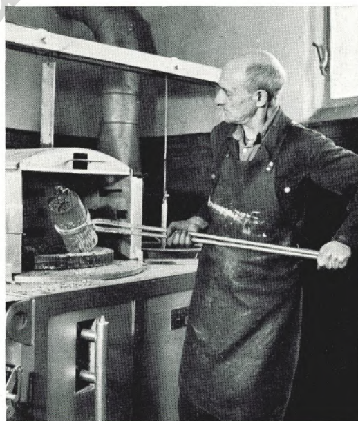
Oft seit Generationen arbeitet die Belegschaft im Lennowerk; hier bei der Härtung im Salzbad
