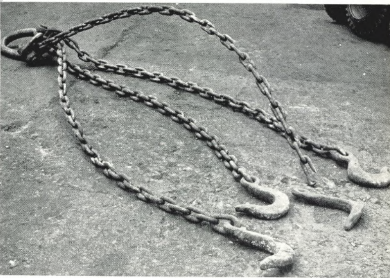
Steifgebogene Kettenstränge mit aufgebogenen Kettenhaken sind in höchstem Maße unfallanfällig, auf der oberen Kette außerdem noch ein gerissenes Kettenglied. Diese Ketten hätte man schon längst der Kettenschmiede übergeben müssen
