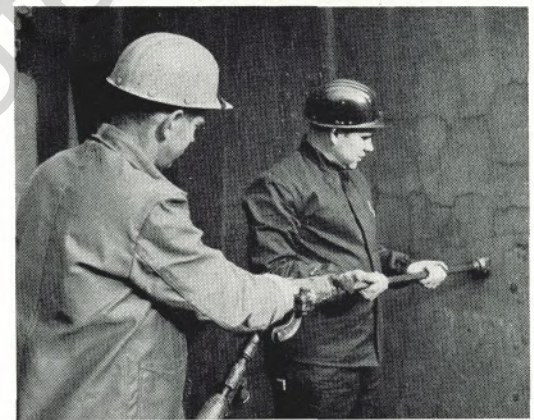
Bei Arbeiten mit der Bohrmaschine ist es nicht ratsam, Handschuhe zu tragen, wie die beiden oberen Bilder zeigen. In mehreren Fällen wurden dadurch schwere Hand- und Armbrüche verursacht, weil der Bohrer die Handschuhe erfaßte und mitnahm. Beim Bohren also: Handschuhe aus!
