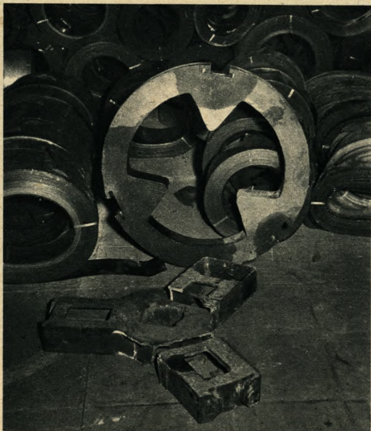
Dieser gußeiserne Einsatz (stehend) brachte gegenüber dem aus Chromnickelstahl erhebliche Vorteile
