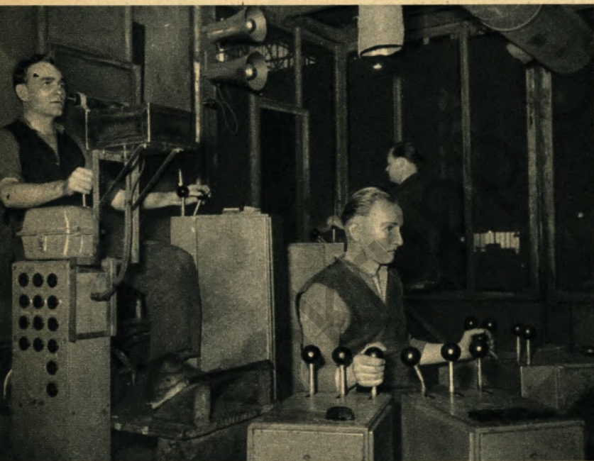
Steuerstand für die Blockstraße, (von links nach rechts: 1. Steuermann: Georg Menge, 2. Steuermann: Günter Schmidt, 3. Steuermann: Heinrich Maier)
