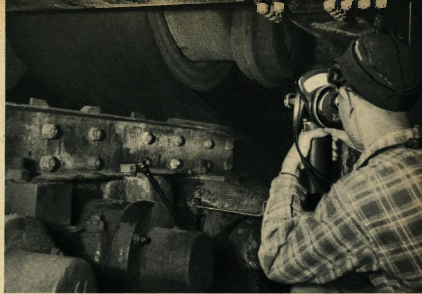
Auswickeln eines Bandes auf einen Warmbaspelkörper während der Walzung. Mit optischen Meßinstrumenten wird die Temperatur kontrolliert
