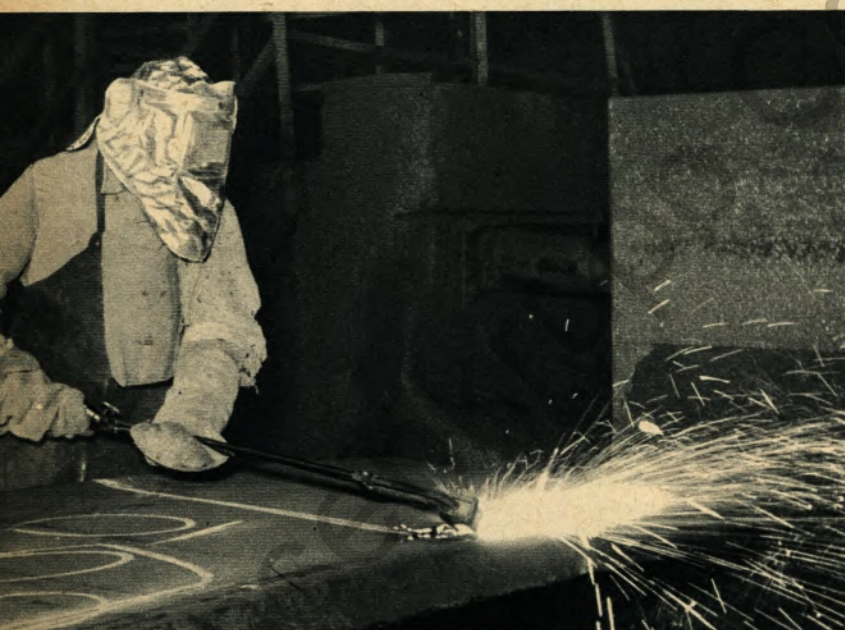
Verputzen einer Vorbrammenoberfläche mit Handflammer. Der Mann trägt einen Körper- und Gesichtsschutz aus Asbest mit Aluminiumpulverauflage.
