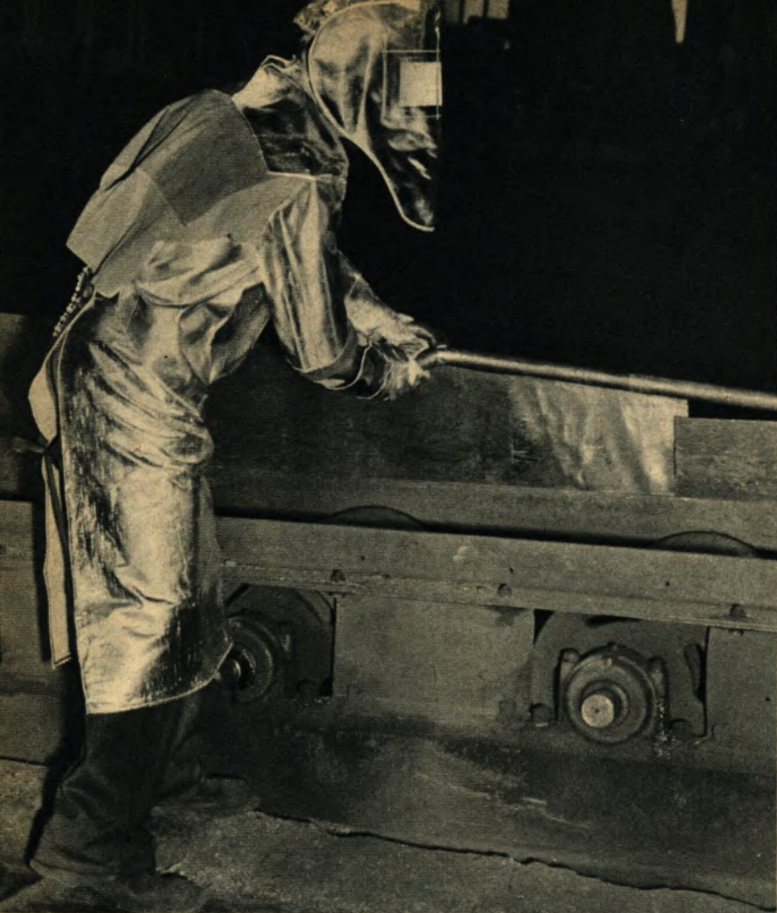
Arbeiter mit Strahlungs-Schutzanzug aus strahlungsabweisendem Baumwollstoff, der auf einer Seite mit Aluminiumfolie überzogen ist
