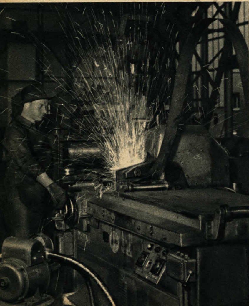
Stumpfschweißen von Bändern im Hohenlimburger Walzwerk
