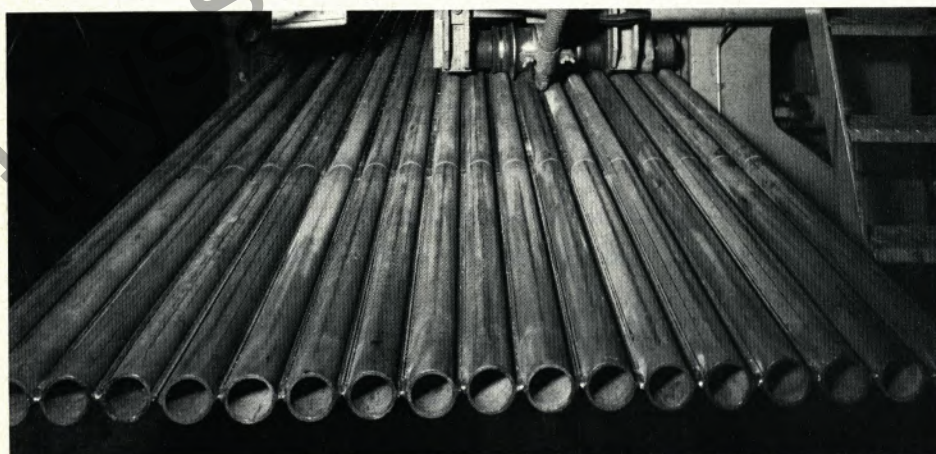
Eine gasdichte Kesselwand aus befloßten Rohren zusammengeschweißt. Über die Herstellung von befloßten Rohren im Werk Poensgen berichten wir ausführlich Seite 14
