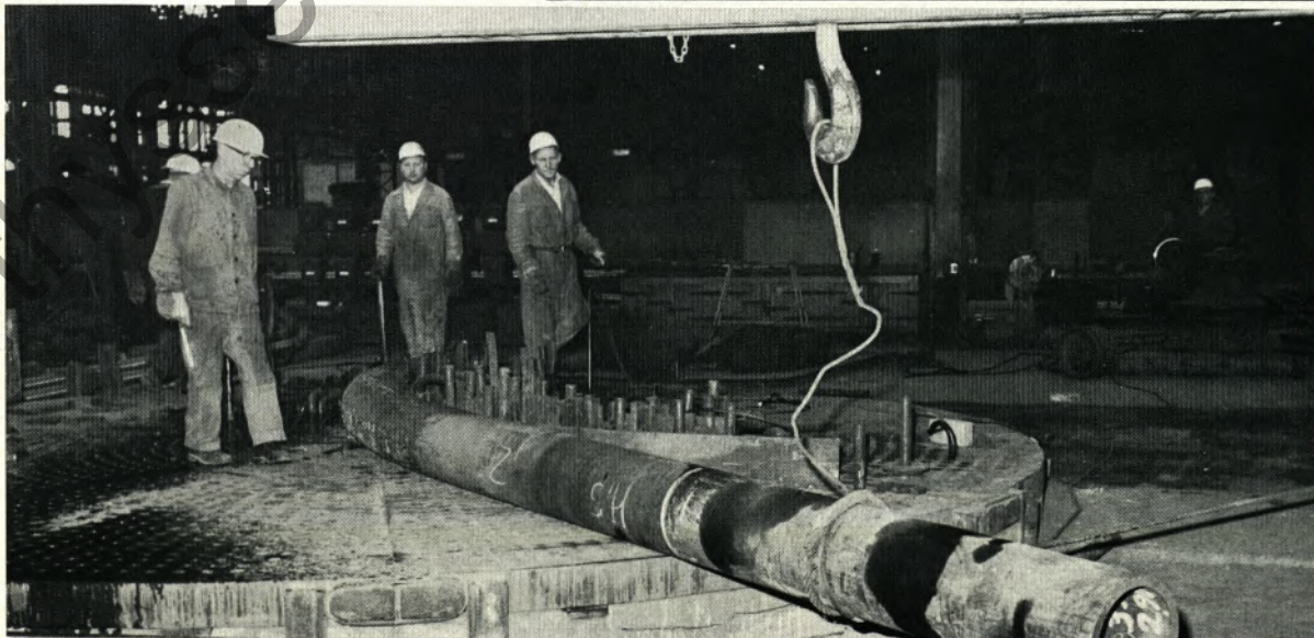
Das Warmbiegen von Rohren für Mineralölleitungen von 50 cm Durchmesser im Werk Poensgen zeigt unser Foto. Von l. nach r. die Rohrbieger Ross, Langer und Klocke.
