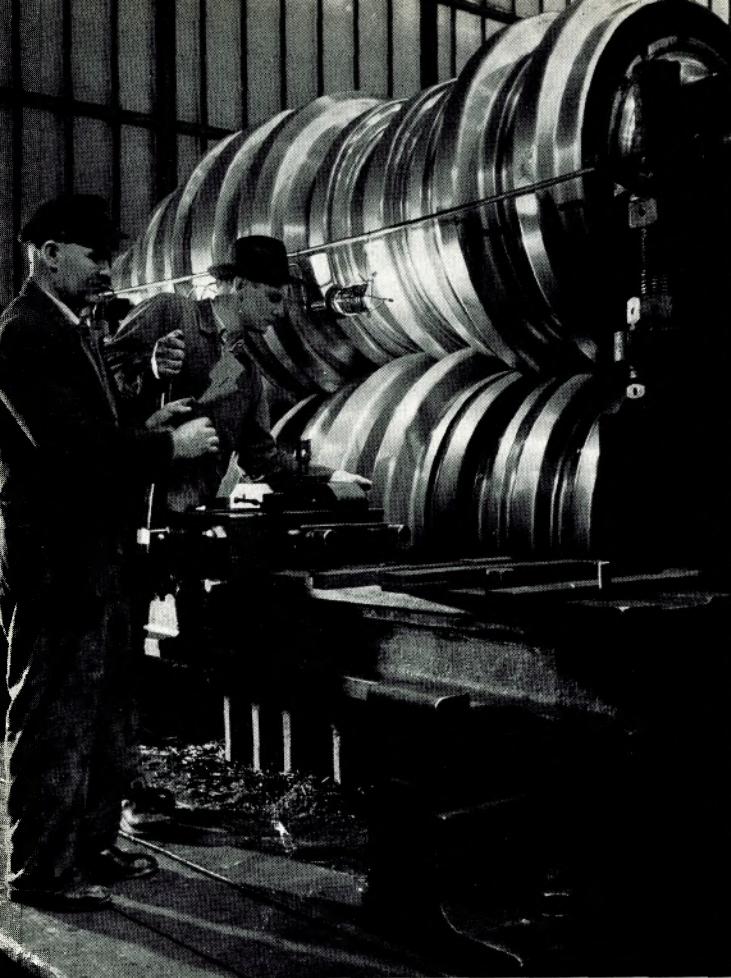
Vorarbeiter Wittrop und Walzendreher Siefert vor einem 18 Tonnen schweren Walzenpaar der Straße 1 an der Drehbank der Walzendreherei
