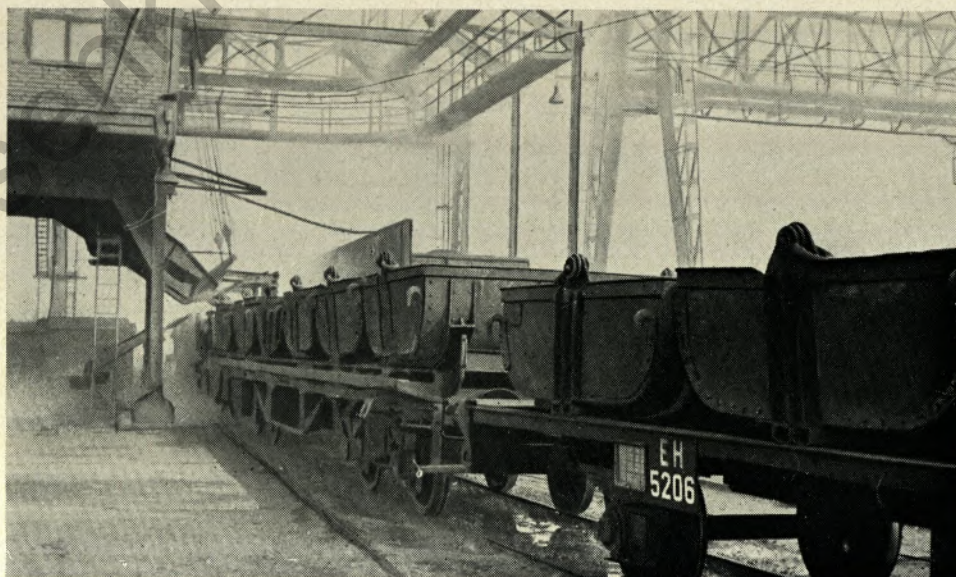
An der Abwurftrampe (links im Bild) stehen die Roheisenkübelwagen bereit und nehmen das zu Masseln erkaltete Roheisen auf.
