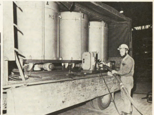
Übernahme von 3.000 l Schmierfett für die Zentralschmieranlage Rohrwarmstraße II, das entspricht dem Inhalt von 15 der üblichen Fässer
