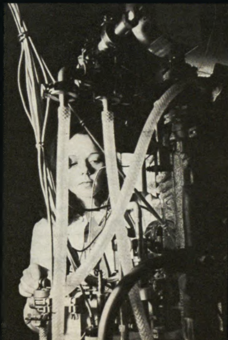
Einlegen einer Stahlprobe in das Dilatometer, ein Gerät zur Messung von Wärmeausdehnungskoeffizienten
