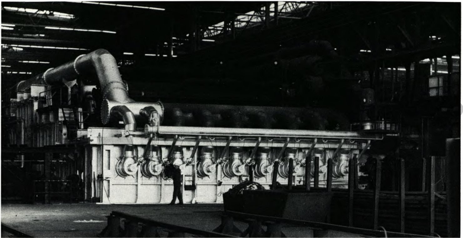
Ansicht der Brennerseite des Stoßofens
