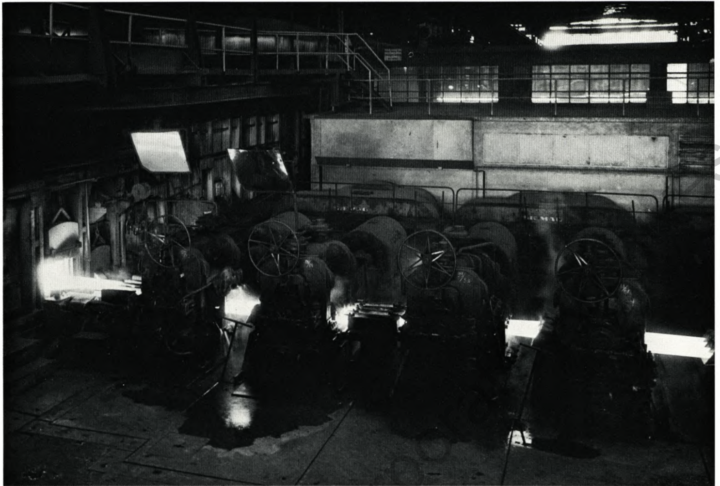
Zwei Ansichten der Vorstraße. Auf dem aus einem anderen Blickwinkel aufgenommenen kleineren Bild sind die acht Gerüste und die vier Adern deutlich zu erkennen
