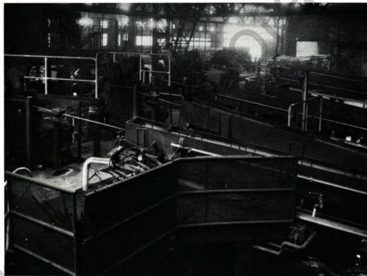
Die der Drahtstraße III. Links anschließend befinden sich die Treiber, die den Walzdraht in die Haspeln treiben. Das untere Bild zeigt die Schlingentische hinter Gerüst 12 aus der Sicht des Kranführers.
