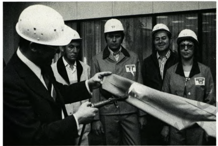
Probe auf's Exempel am Thyssen-„flammpfest“-Sicherheitsanzug.
