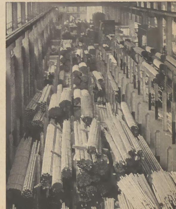
Das geräumige Versandlager in Halle 3 gestattet eine übersichtliche Lagerung nach verschiedenen Gesichtspunkten wie Inland, Export, Innerdeutscher Handel und Kunden. Auf der einen Stirnseite befindet sich ein Gleisanschluß, während gegenüber auf LKW verladen wird.
