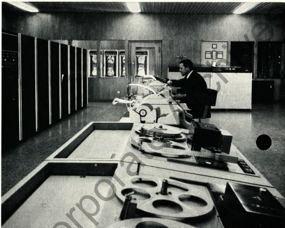
Ein Blick in das „Gehirn“ der Rohrkontistraße, wo ein Dispositionsrechner die vorliegenden Aufträge zu detaillierten Arbeitsanweisungen zusammenstellt, und ein Prozeßrechner aufgrund der Arbeitsanweisungen des Dispositionsrechners den Produktionsablauf überwacht.
