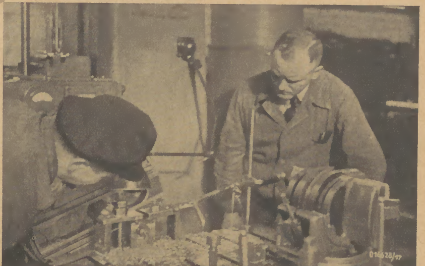
Der Horizontalbohrer im ABWA.
