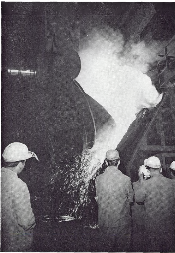
Das neue Oxygen-Stahlwerk Bruckhausen, das eine Rohstahl-Kapazität von mehr als 300 000 Monatstonnen besitzt, hat nach achtzehnmonatiger Bauzeit am 29. September den Betrieb aufgenommen. Dieses dritte Oxygen-Stahlwerk der ATH, das zu den größten der Welt gehört und dessen zwei Konverter ein Gefäßvolumen von je 250 Kubikmeter besitzen, wird sowohl phosphorarmes als auch phosphorreiches Roheisen verarbeiten. — Unsere Bilder zeigen (links) den Einsatz von Roheisen in den Konverter und (rechts) den Kokillenguß. (Die Werkzeilung wird das neue Werk der Belegschaft noch ausführlich vorstellen.)
