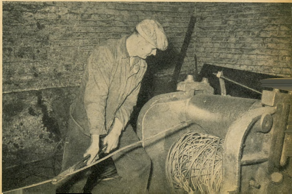
... und so steckt er den Schrott in den gefährlichen Schrotthaspel
