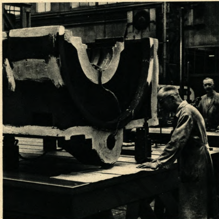
6. In der Halle des Werkzeugmaschinenbaus übernimmt der Anreißer das geputzte Gußstück, überprüft es auf eventuelle Maßfehler und reißt es an, das heißt, er bringt Markierungen für die spätere Bearbeitung durch Hobeln, Fräsen, Bohren, Drehen an. Hier sehen wir Vorzeichner Franz Krämer beim Anreißern des Spindelstocks einer Drehbank.
