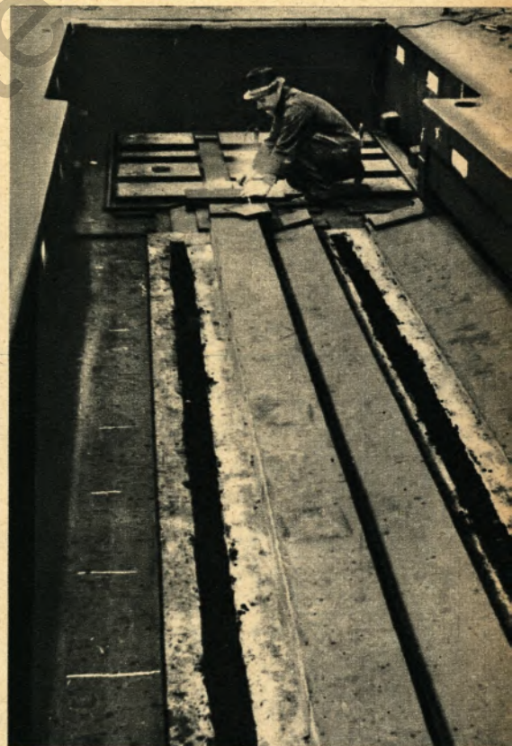
3. Nach dem Modell entsteht in der Formerei die Gußform des Maschinenteils. Former Hans Rumpa ist hier gerade dabei, die Form für den Bettkopf einer Großdrehbank fertigzustellen.
