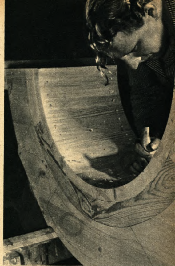
2. Nach den Unterlagen des Konstruktionsbüros werden in der Modellschreinerei die Modelle der Gußstücke angefertigt, die zum Herstellen der Gußformen dienen. Modelltischler Gerhard Rüter bearbeitet hier gerade das Modell.
