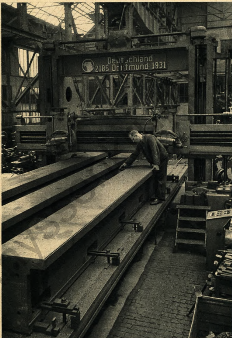
10. Inzwischen ist auf der Hobelmaschine das Drehbankbett gehobelt. Auch hierbei ist es wichtig, bis auf Bruchteile eines Millimeters maßhaltig zu arbeiten. Daher prüft Hobler Franz Hahne hier gerade die Breite einer Führungsbahn nach.
