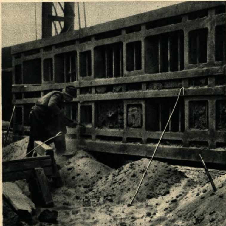
5. Nach dem Erkalten wird das Gußstück aus der Form geholt und geputzt. Hier werden die Kerne von der Unterseite eines Drehbankbettes entfernt. Das Gußstück hat ein Gewicht von 26,3 Tonnen, eine Länge von rund 9 Metern und eine Breite von 2,34 Metern.
