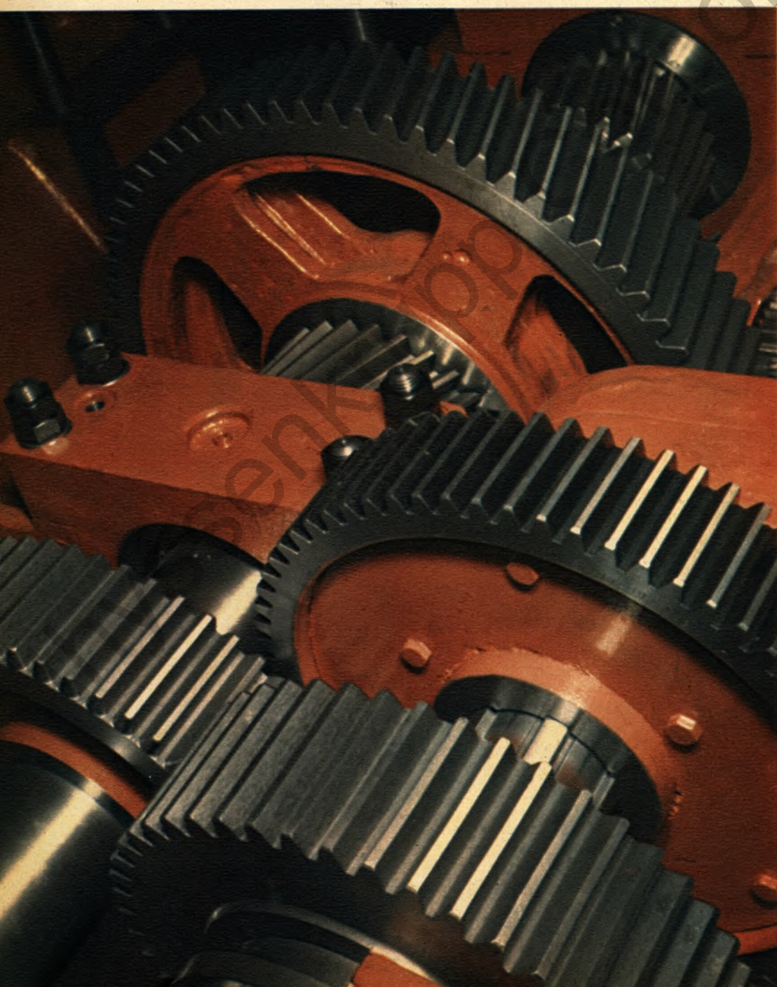
7. Ein Blick in den Getriebekasten einer Großdrehbank zeigt, mit welcher Präzision und Sorgfalt gearbeitet werden muß, wenn dieses vielfältig ineinandergreifende Getriebe sorgfältig, dauerhaft und geräuscharm laufen soll. Das Getriebe übersetzt die Kraft des Antriebsmotors auf die beweglichen Teile der Drehbank.
