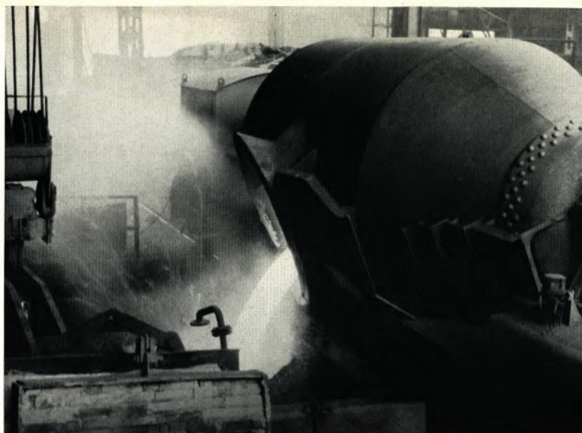
Mischerwagen beim Abfüllen flüssigen Roheisens für das Stahlwerk
