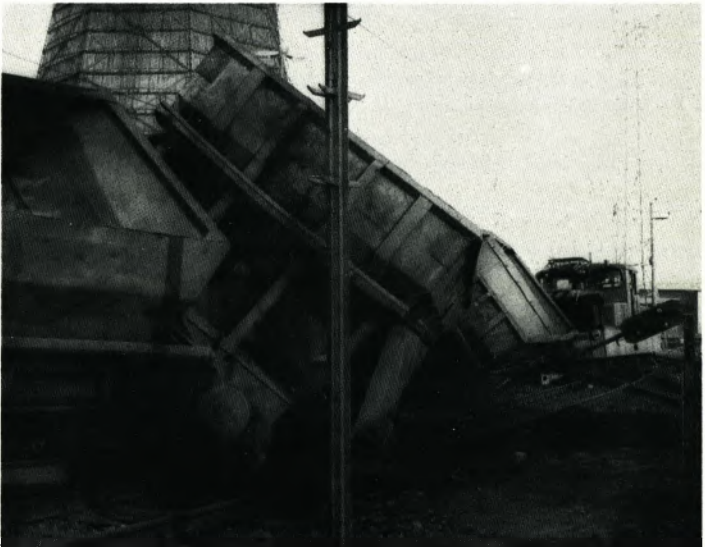
Durch mangelhafte Fahrwegbeobachtung wurde ein „Halt“ zeigendes Signal durchfahren. Es kam zur Flankenfahrt mit einer anderen Einheit. Dabei wurden 15 EH-Wagen beschädigt. Schadenskosten ca. DM 78 500,-
