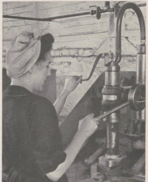
Kernmadrin an moderner Kerblastmaschine
