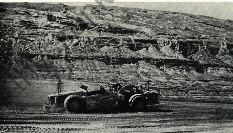
In Marampa wird der Abbau inzwischen nach ganz modernen Methoden vorgenommen. Dieser im Tagebau eingesetzte Scraper faßt 20 bis 25 Tonnen Eisenerz. Er wird von einem Afrikaner gefahren
