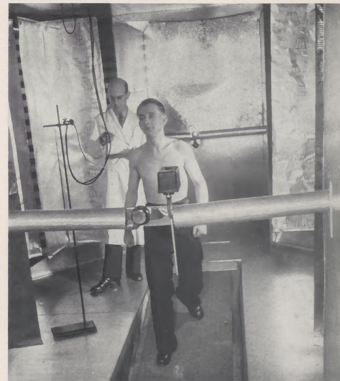
Innerhalb der Klimakammer, die hermetisch abgeschlossen ist, befindet sich eine Tretbahn, die auf verschieden große Geschwindigkeit geschaltet werden kann. Außerdem kann die Tretbahn in zwei Richtungen geneigt werden, um die gleichen Bedingungen zu schaffen, wie sie beim Bergauf- oder Bergabgehen vorliegen. Zusätzlich wird Hitze oder Kälte, Feuchtigkeit oder Trockenheit und ein besonderer Luftstrom erzeugt. Die Versuchspersonen stehen unter dauernder ärztlicher Kontrolle. Der Pulschlag wird ständig gemessen und der Blutdruck kontrolliert, um Erfahrungen darüber zu sammeln, welches Maß körperlicher Anstrengung unter verschiedenen klimatischen Bedingungen zumutbar ist und überhaupt ertragen werden kann.
