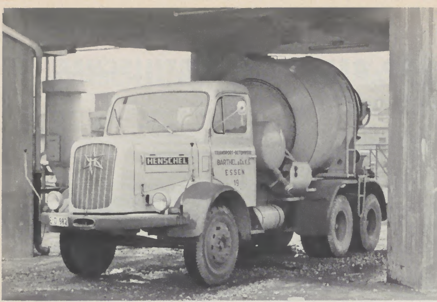
HS 3-125 mit Krupp-Dolberg-Aufbau. Die Trommel unter dem Füllurm, in dem die Betonkomponenten dosiert werden. Die Füllung dauert 3 Minuten.
