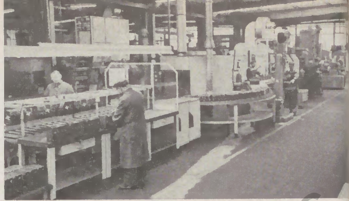
Schlußarbeits- und Kontrollplätze der Zylinderkopfstraße für Motoren 520.
