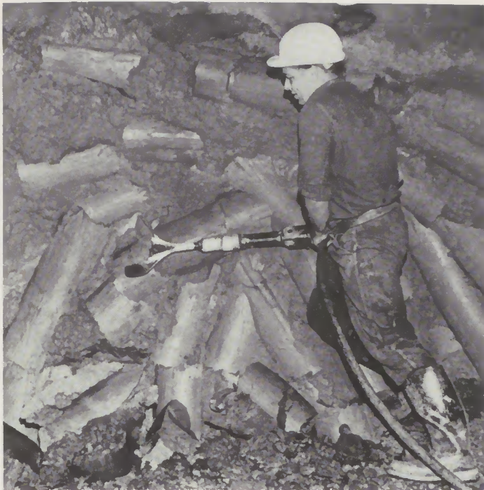
Tongrube Melsbach, Hauer mit Preßluft-Spatenhammer
