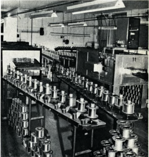
Ausschnitt aus der Feindrahtfertigung des NE-Metall-Bereiches. Im Vordergrund Ablaufgestell mit Metallspulen (Ziehspulen), die einem elektrischen Glühofen mit indirekter Beheizung vorgeordnet sind.
