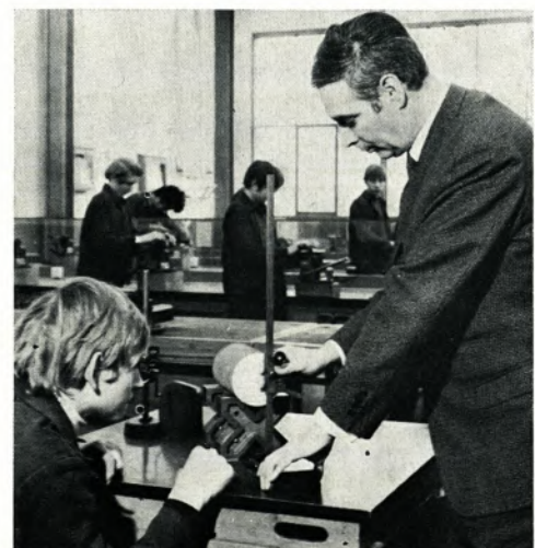
Ing. Günter Schmitt unterweist den Starkstromelektrikerlehrling Michael Sodenkamp (15 Jahre) an einer Anreißplatte im Umgang mit einem Parallelreißer.
