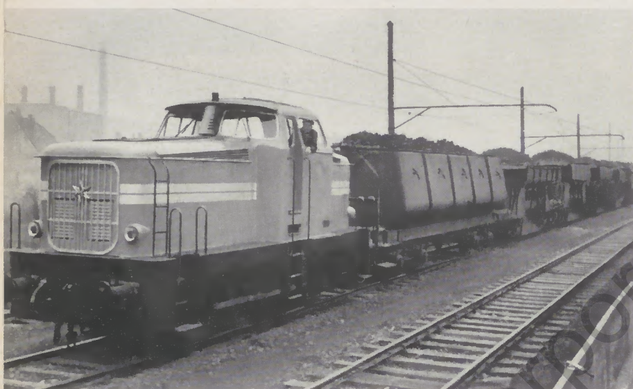
Diesel-hydraulische Lokomotive DH 360 (360 PS) im Ruhrgebiet
