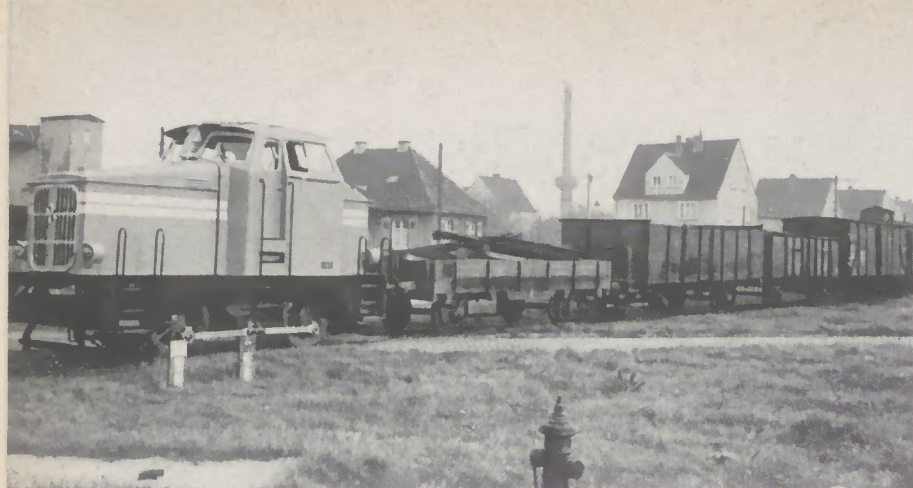
Diesel-hydraulische Lokomotive DH 240 (240 PS) im Strecken- und Rangier-Dienst einer Industriebahn
