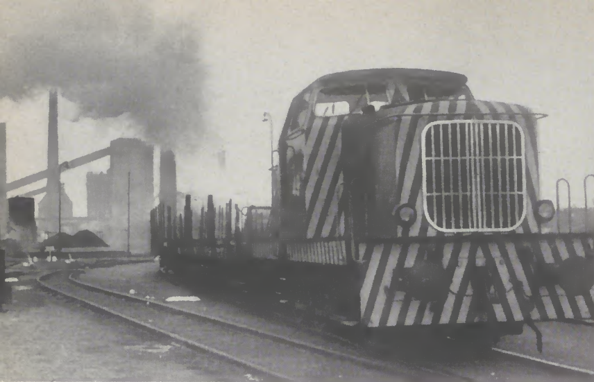
Diesel-hydraulische Lokomotive DH 500 (500 PS) in einem westfälischen Großbetrieb
