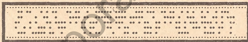
Abb. 5. Darstellung der Zeichen durch Lochschrift im Sendestreifen. Lochstreifen dieser Art werden zum Senden in Siemens-Schnell- und Pendeltelegraphen in gleicher Weise verwendet
