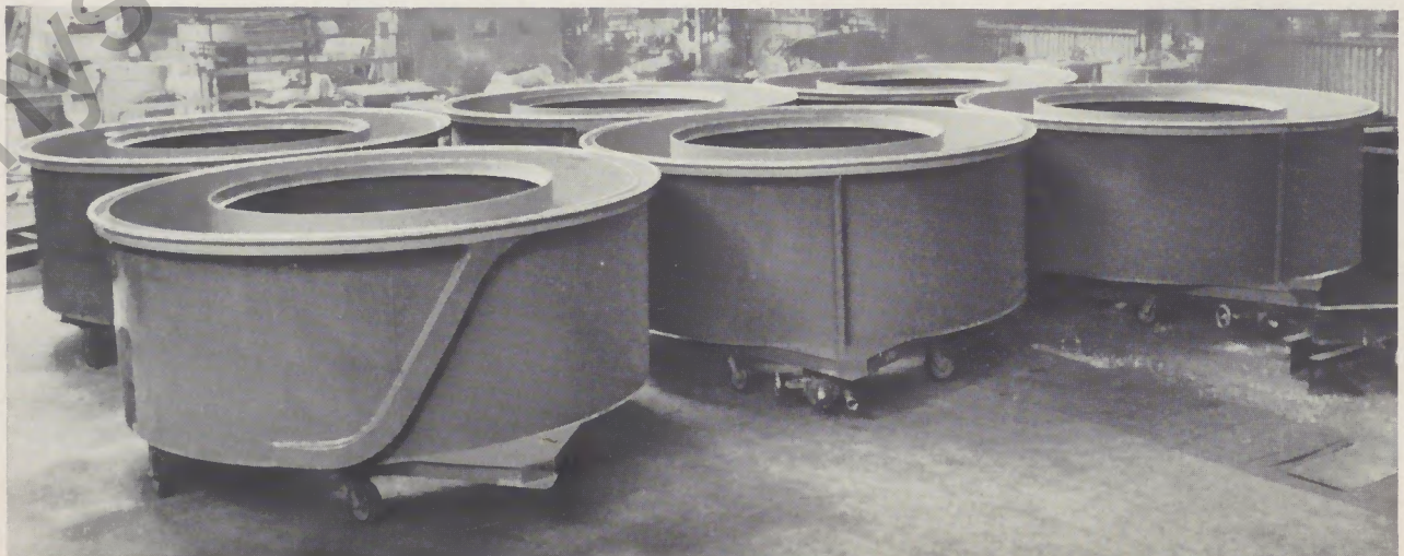
Abb. 2 Eine Serie Meßpfannen zum Prüfen von Seekabeln
