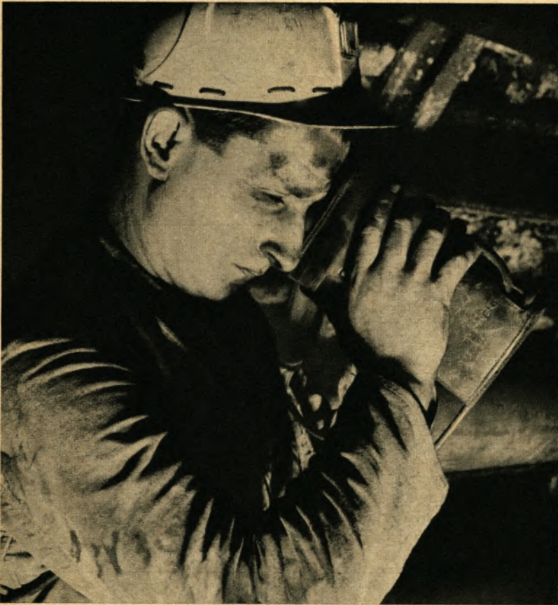
▲ Hier liest Gerhard Willun das Interferometer ab, mit dem geprüft wird, ob der Wetterstrom Grubengas enthält
