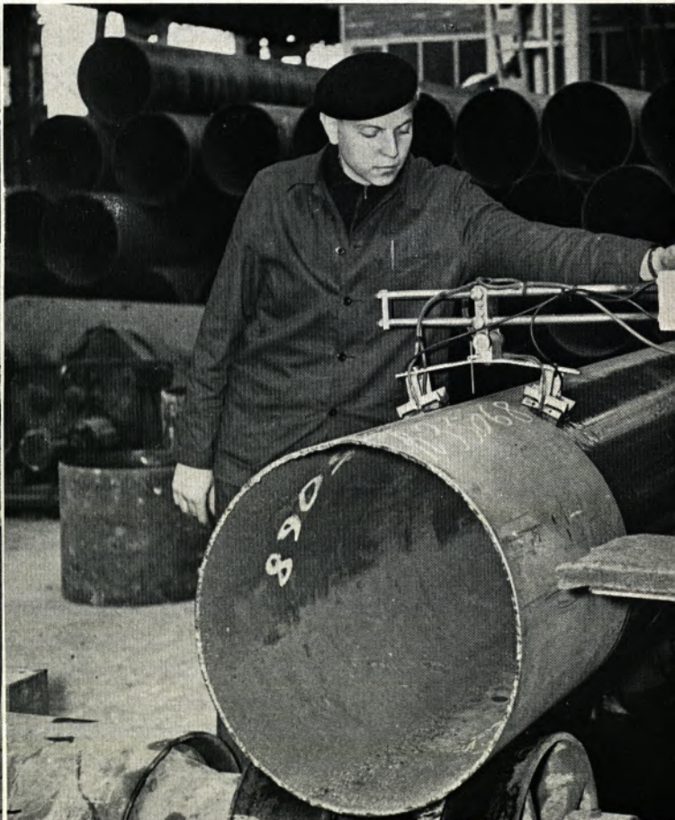
Mit modernen Ultraschallgeräten werden die Schweißnähte unserer Rohre auf Fehler geprüft. Auf dem Bildschirm des US-Geräts beobachten die Werkstoffprüfer
