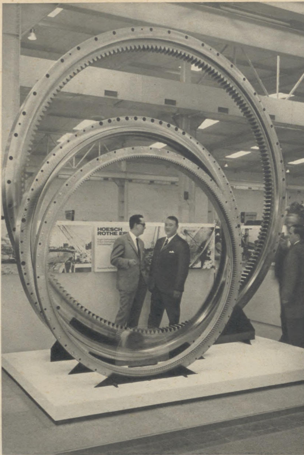
◀ In doppelter Mannshöhe ragten auf dem Stand des Eisenwerkes Rothe Erde in der Halle 4 vor den Fotos mit Anwendungsbereichen der Erzeugnisse Kugeldrehverbindungen auf
