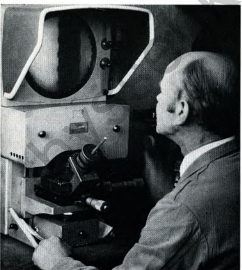
Prüfen der gerippten Drähte auf Maßhaltigkeit mit dem Profilprojektor.
