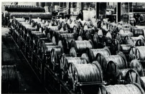
Ablauf der Drähte zur Schweißmaschine.
