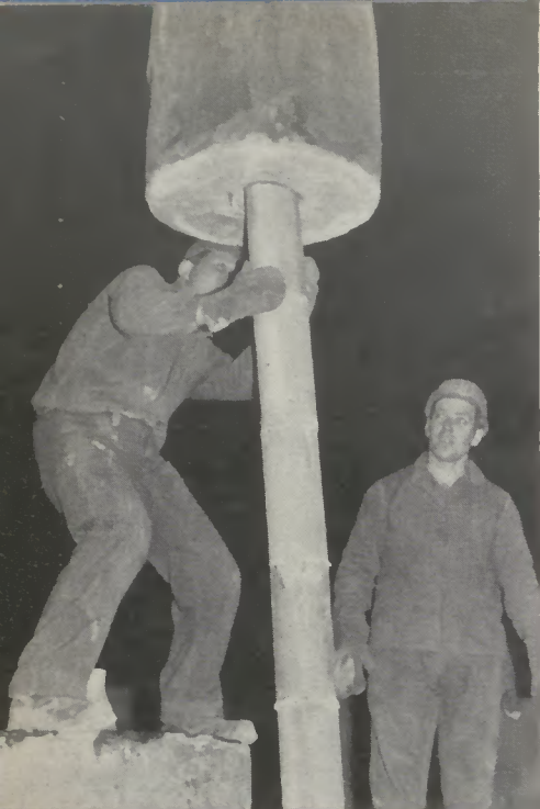
Die Gießer Helmut Beckmann und Hans Perrenbreiter stellen einen Gießtrichter auf.
