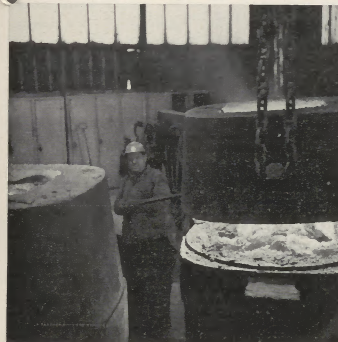
unten links: Die fertigen Blöcke werden aus ihren Formen, den Kokillen, gezogen. Gießer Otto Eggert zieht die Blockhäuben ab und
