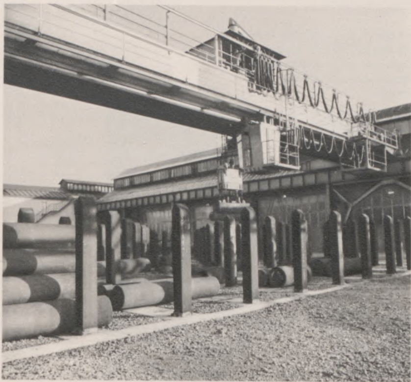
◀ Die 4000-Tonnen-Hydraulikpresse staucht und locht den Vorblock zur Scheibe
