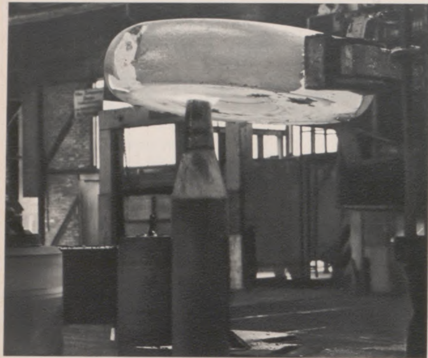
► Vertikal und horizontal rotierende Walzen weiten die Lochscheibe zum Ring
