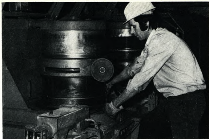
Drahtzieher Walter Benko beim Einziehen des Drahtes.
