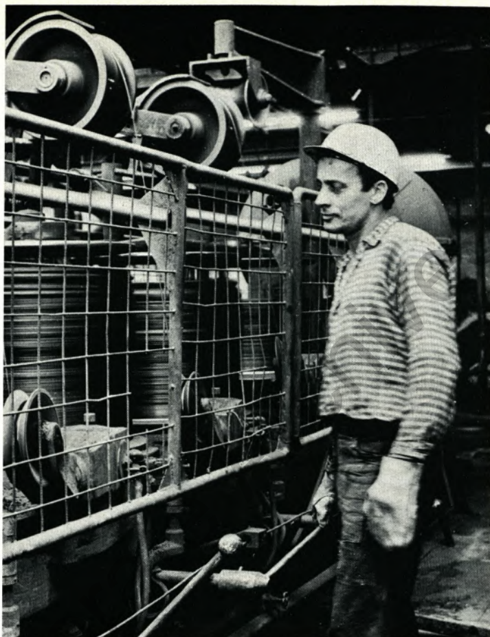
Eine der Überkopf-Ziehmaschinen, die für die Herstellung von Stahldraht einfacher Qualitäten im Werk Gelsenkirchen noch im Einsatz sind. Deutlich ist zu erkennen, wie der Draht überkopf zur nächsten Ziehscheibe heruntergezogen wird. Drahtzieher Ernst Meyer schaltet gerade eine Scheibe aus und überwacht den Ziehvorgang.
