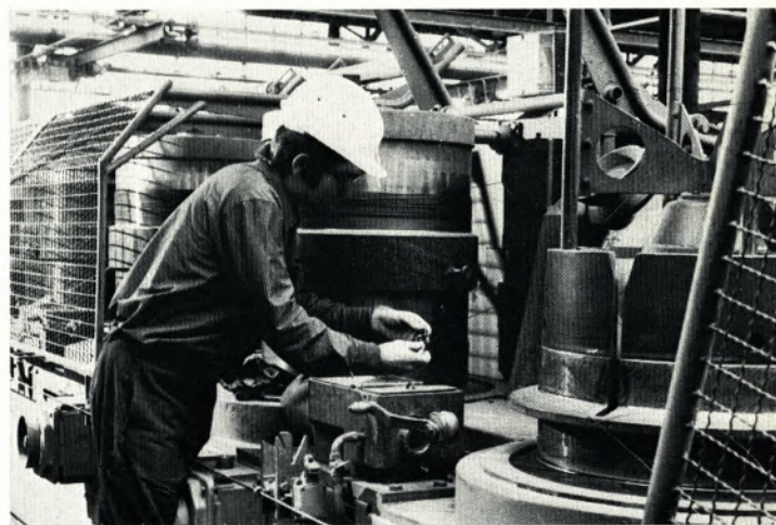
Drahtzieher Gerd Risse kontrolliert mit der Mikrometerschraube die Drahtabmessung.
