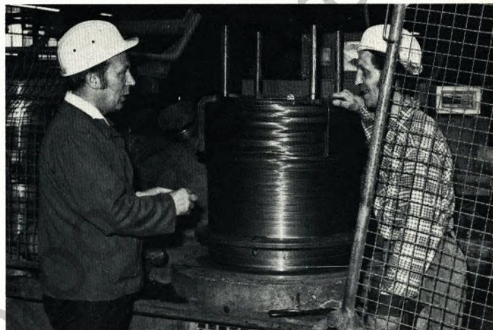
Meister Georg Kies (links) und Drahtzieher Karl-Heinz Bienik beim Kontrollieren der Querschnittsabnahme.
