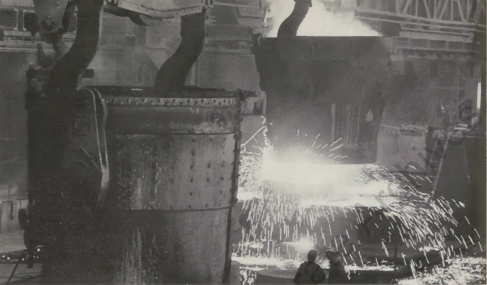
Ruhrstahl Henrichshütte (Hattingen): Gießen eines Schmiedeblocks im Stahlwerk (oben) und Schmieden eines Ringes an der 6000-t-Pressen im Preßwerk ►
