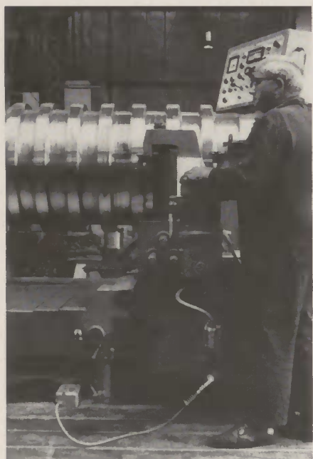
Rückseite: Heinrich Panhorst überprüft eine der beiden Drehbänke, die die Maschinenfabrik Deutschland für die Profilwalzwerke der Hüttenunion gebaut hat. Diese Drehbänke können Werkstücke bis zu 30 Tonnen Gewicht aufnehmen
