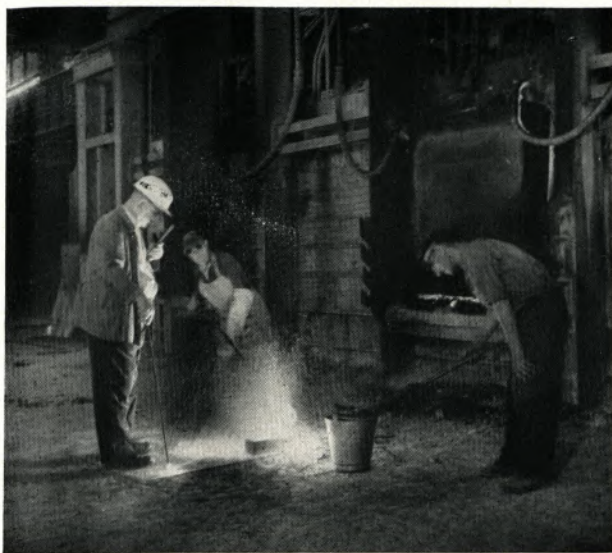
Auf der Ofenbühne des neuen Ofens II wird eine Probe entnommen
