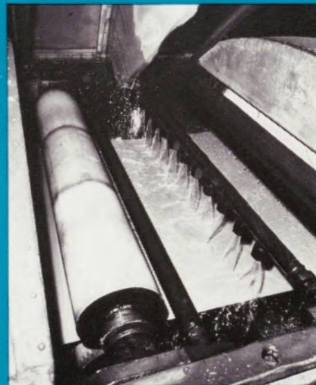
Dieses Edelstahlband wird mit entsalztem Wasser gewaschen. Dies ist nur ein Beispiel für die viel- fältige Verwendung von Wasser im Werk Krefeld. Zum Beitrag Seite 10-12.
